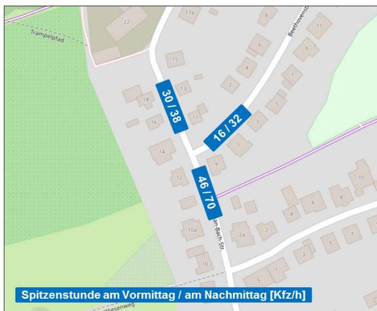
**Bild 2:** Querschnittsbelastungen im Prognosefall in der Spitzenstunde am Vor- und Nachmittag
