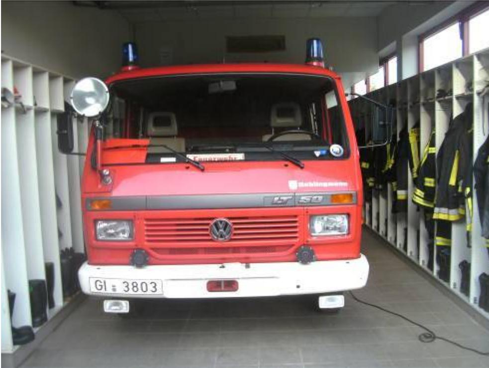
Die Unterbringung der Einsatzkleidung in der Fahrzeughalle entspricht nicht den Anforderungen nach DIN 14092 und der Informationsschrift - Sicherheit im Feuerwehrhaus. – (GUV-I 8554) Es werden die nach UVV-Feuerwehren § 4 Abs.2 vorgeschriebenen Verkehrswege nicht eingehalten. Eine Gefahr durch Dieselabgaskontamination ist nicht auszuschließen. Die Kleidung der Jugendfeuerwehr ist als Sofortmaßnahme aus der Fahrzeughalle zu entfernen und beispielsweise im Schulungsraum zu lagern..
